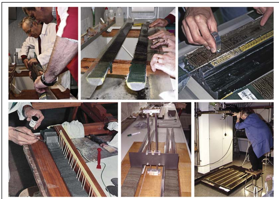
Fig. 3.1.2. Carotatore a gravità, taglio longitudinale e sub campionamento della carota di sedimento.
