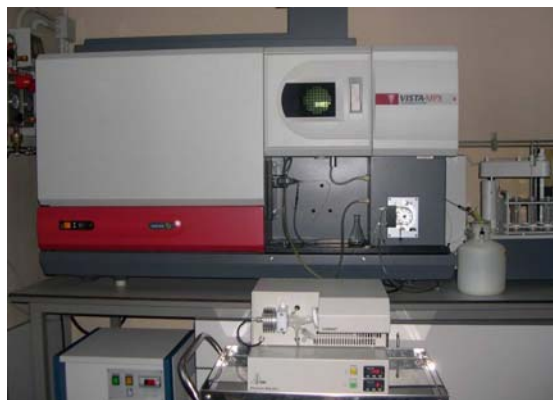
ICP-OES Varian Vista-MPX con torcia assiale, nebulizzatore ad ultrasuoni CETAC U5000AT + ed autocampionatore SPS5
