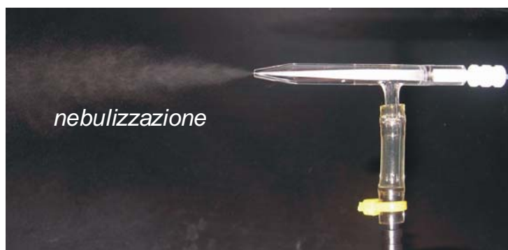
Esempio del controllo della nebulizzazione con nebulizzatore concentrico o di Meinhard
