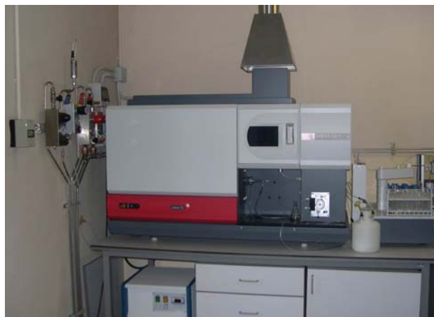
ICP Varian Vista-MPX con torcia assiale ed autocampionatore SPS5
