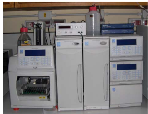
Sistema cromatografico Dionex DX320 con autocampionatore AS50
