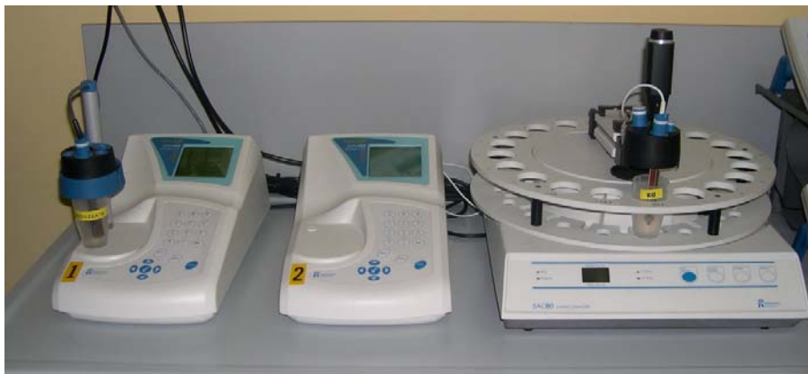
pHmetro e conduttimetro Radiometer ION450 con autocampionatore SAC80
