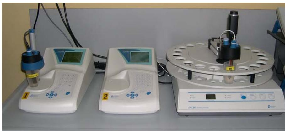
pHmetro e conduttimetro Radiometer ION450 con autocampionatore SAC80
