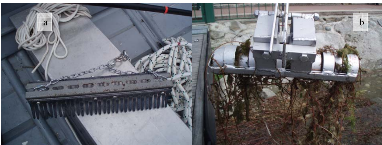
Fig. 14. Rastrello (a) e draga di Ponar modificata (b).
