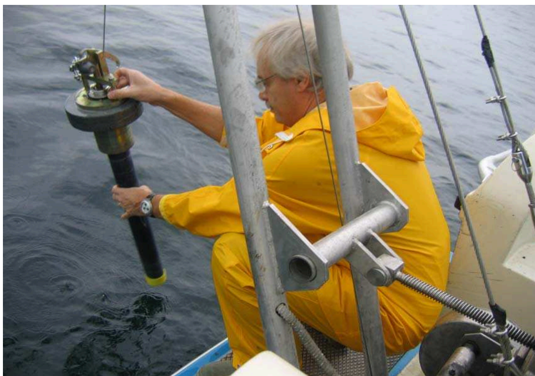
Fig. 3.1.2. Prelievo di sedimento lacustre mediante carotatore a gravità.
